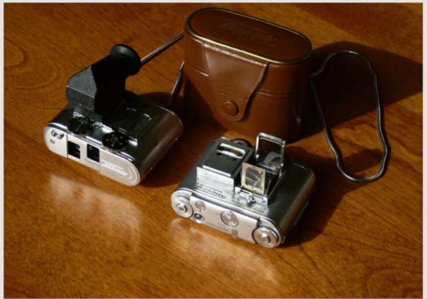
Die Tessina-Kamera war als zweiäufige Spiegelreflexkamera ausgelegt. Als Zubehör gab es einen Durchsichtssucher (links). Rechts mit dem mitgelieferten Aufsichtssucher. Foto Wikimedia Commons.
