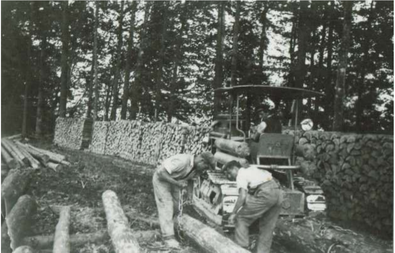
Abb.15: Auf diesem Bild aus dem Jahr 1941 ist ein Raupentraktor zu erkennen. Er erleichterte die Rodungsarbeiten in hohem Mass, war aber noch nicht sehr verbreitet. Das Bild dürfte ebenfalls in Langenhard entstanden sein. Bild Privatarhiv Hedi Werren.
